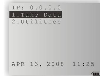
注意：Batch AG 支援自動上傳資料(Auto Upload)。當 8200 透過 RS-232 或 USB Virtual COM 傳輸線連接到電腦時，AG 功能選單同時會出現漏斗圖示，表示等候自動建立連線以上傳資料。
